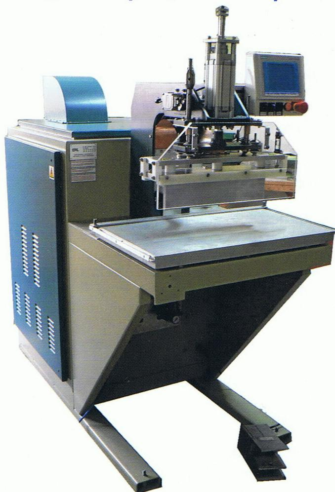
Nos soudeuses haute fréquence sont conçues pour réaliser efficacement des soudures étanches de grande qualité sur les produits en film PVC, PU tels que : les liners de piscine, les stores, les tentes, les panneaux publicitaires, les barrages, les bâches et les produits gonflables.
